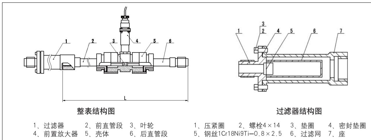
图6 LWGY-4~10传感器结构及安装尺寸示意图
