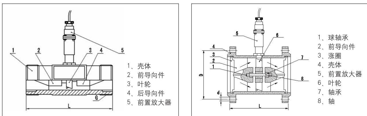
图7 LWGY-15~40传感器结构及安装尺寸示意图
